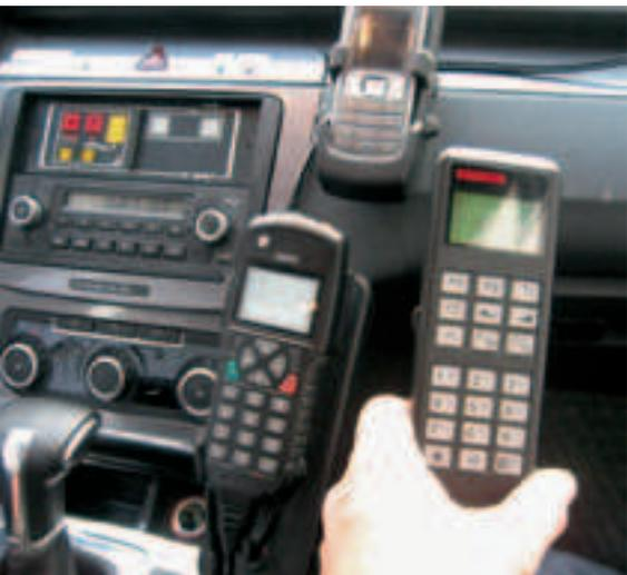
**Basis- und erweiterte MRT (Mobile Radio Terminal, Fahrzeugfunkgerät), die bis zum Echtbetrieb mit den analogen Geräten im Fahrzeug betrieben werden. Darüber befindet sich noch das „Diensthandy“ in der Freisprecheinrichtung; dazu kommen dann noch die HRT und unter Umständen auch noch die privaten Handys der Kolleginnen und Kollegen, was sicherlich zu einer erhöhten Strahlenbelastung führen kann, da das Fahrzeug als Faraday-Käfig die Strahlung der Handgeräte nach außen hin abschirmen wird.**
