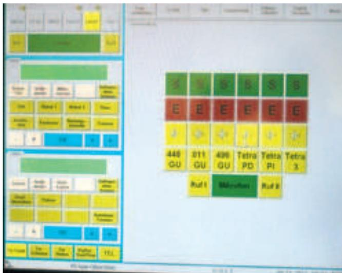
**Feststation auf der Wache, einmal mit analogem Funk und zusätzlich ausgerüstet mit TETRA für den ePB – umschaltbar vom eigenen Dienststellenbereich auf Direktionsbereich usw.**
